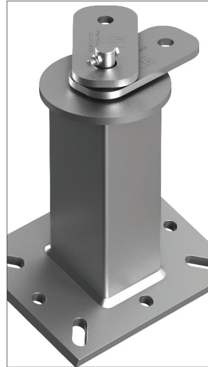
403S € 157,00 ZINCATO A CALDO 4 Fori Ø18 4 Asole 18x45 Peso 14,60Kg
