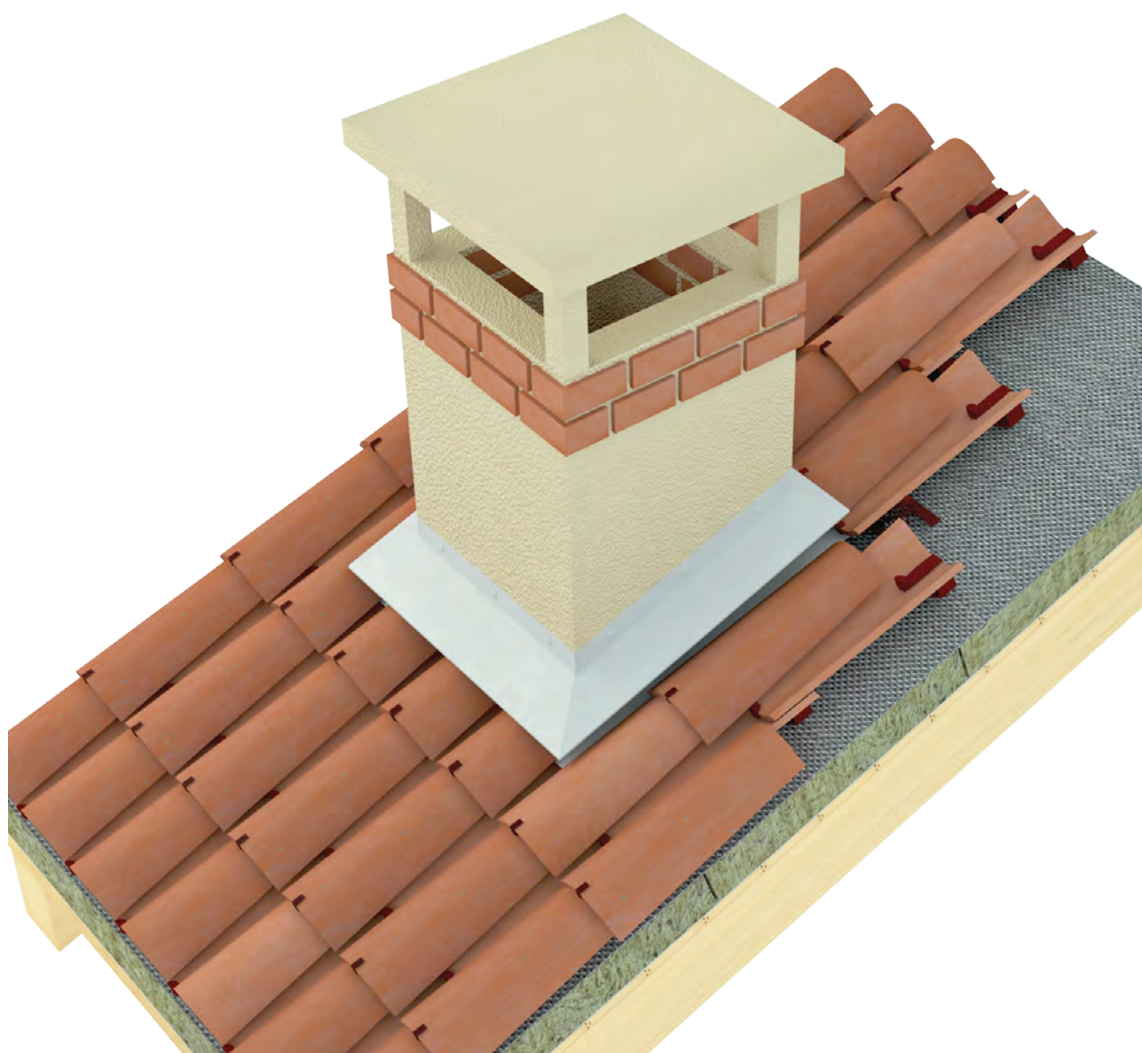
Vista dell'inserimento del camino con il sistema AERcoppo®
