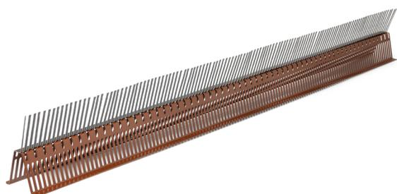
in acciaio zincato e verniciato a polveri epossidiche: elemento universale di partenza per la prima fila di tegole, con la funzione di parapasseri e di agganciare il manto di copertura sulla linea di gronda.
