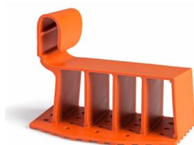
in polipropilene copolimero stabilizzato ai raggi U.V.A.: elemento di rialzo ed ancoraggio, da applicare lateralmente ad ogni tegola. **Non richiede il fissaggio a mezzo meccanico sul piano di posa.**
