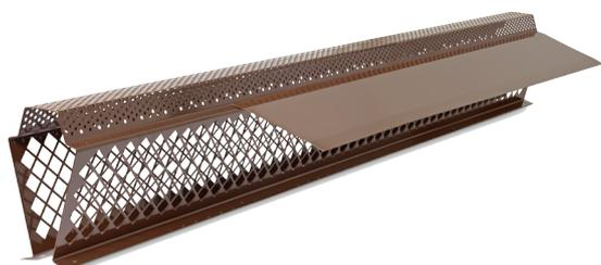
in acciaio zincato e verniciato a polveri epossidiche: elemento di colmo, munito di bandelle protettive in alluminio preverniciato; consente la creazione del colmo ventilato ed il fissaggio dei copponi di colmo in laterizio.
