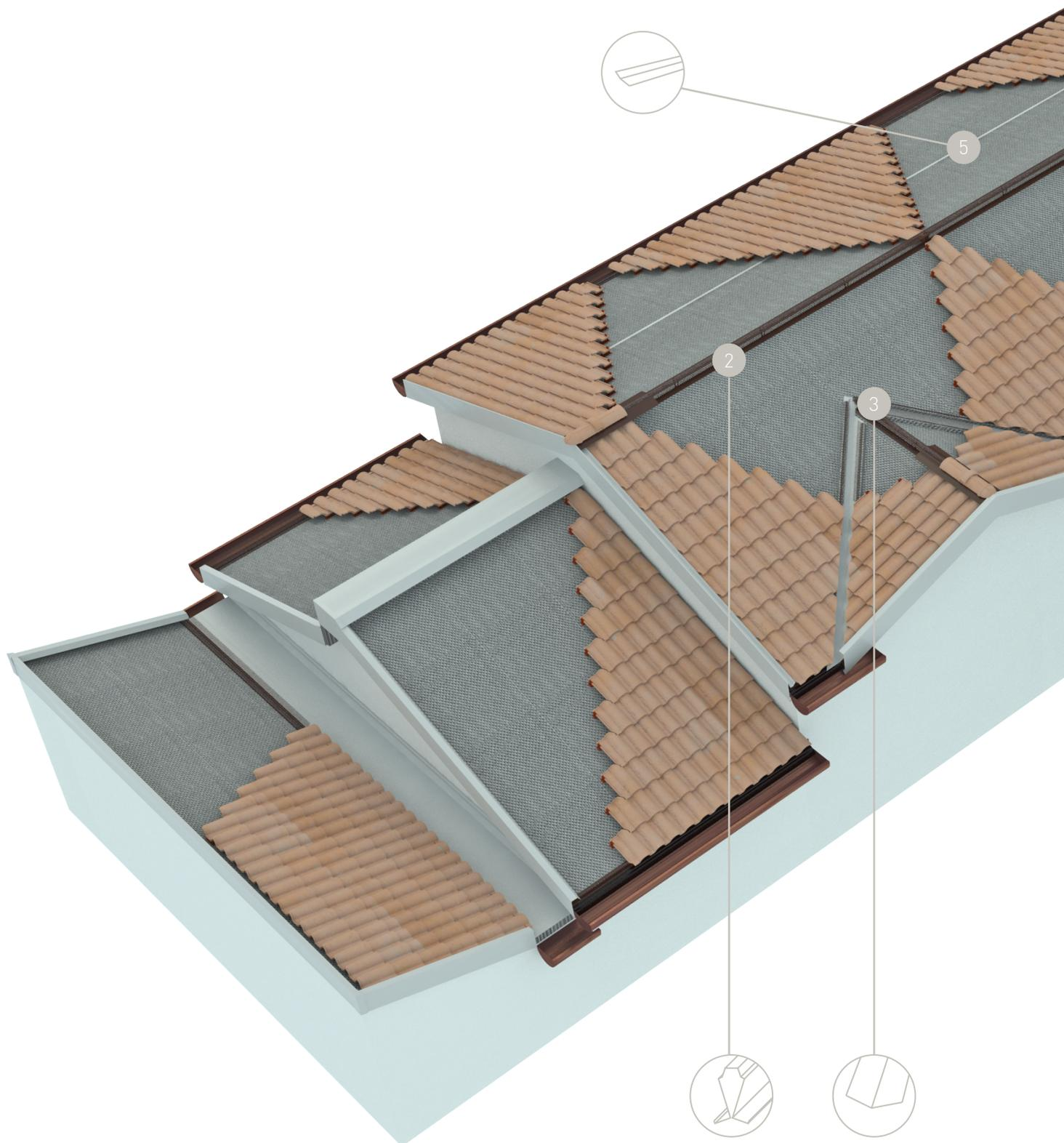
Il sistema di ventilazione brevettato AERtebola® si adatta a qualsiasi tipo di conformazione e dimensione di copertura (due falde a capanna, monofalda, a padiglione, a piramide, con abbaini, ecc). Nell'immagine qui sotto viene raffigurata una copertura in cui sono presenti tutti gli elementi del sistema AERtebola® con la relativa posizione.
